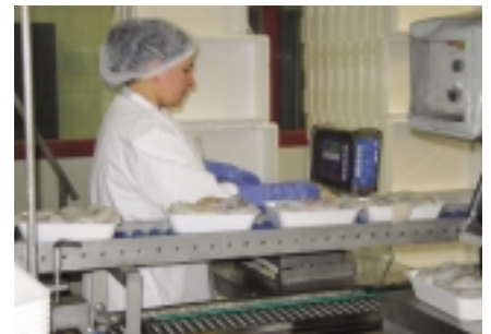
Taratura e pesatura delle vaschette contenenti i filetti di platessa
