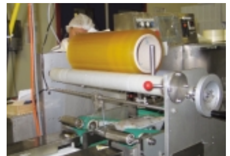
Confezionamento delle vaschette contenenti i filetti di platessa
